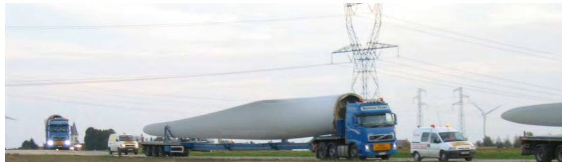
Figure 123 : Illustration du transport des pales (©ATER Environnement)
